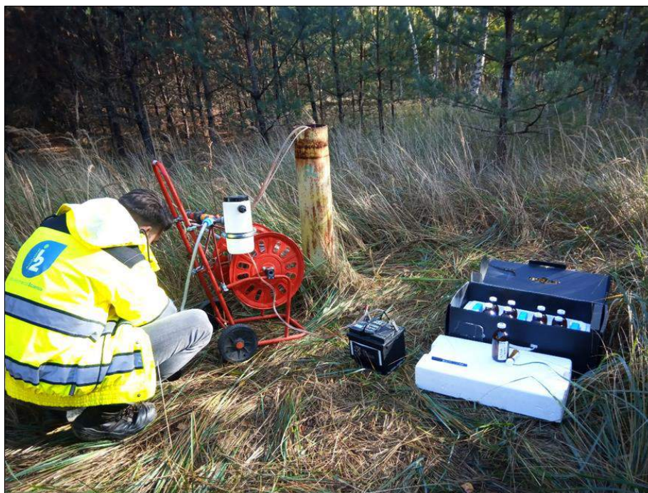
Ryc. 3 Pobór próbki wody z piezometru przez laboratorium I2 Analytico.
