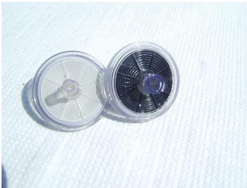
Fot. 2. Filtr strzykawkowy 0,45 \mu\text{m} przed i po filtracji zanieczyszczonych wód podziemnych (fot. D. Pierri)
